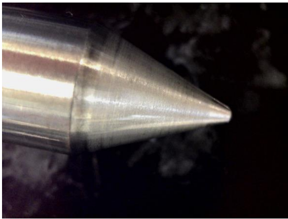
圖 6.6. 空心活塞閥的放大圖 (進行高硫柴油測試前)
