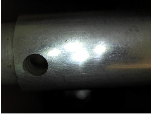
圖 6.10. 燃油泵輸送的放大圖 (進行高硫柴油測試前)
