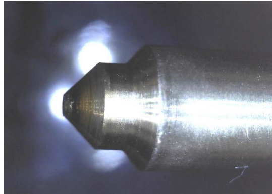
圖 5.13. 空心活塞閥的放大圖 (進行低硫柴油測試後)
