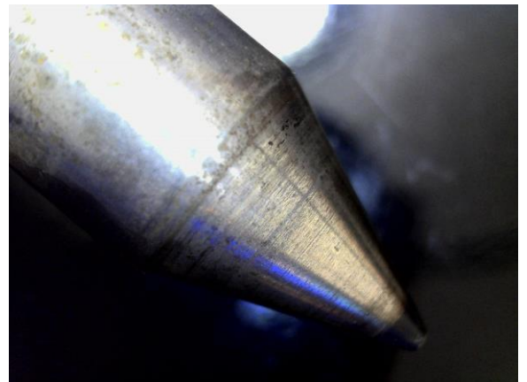
圖 6.7. 空心活塞閥的放大圖 (完成進行高硫柴油測試後)
