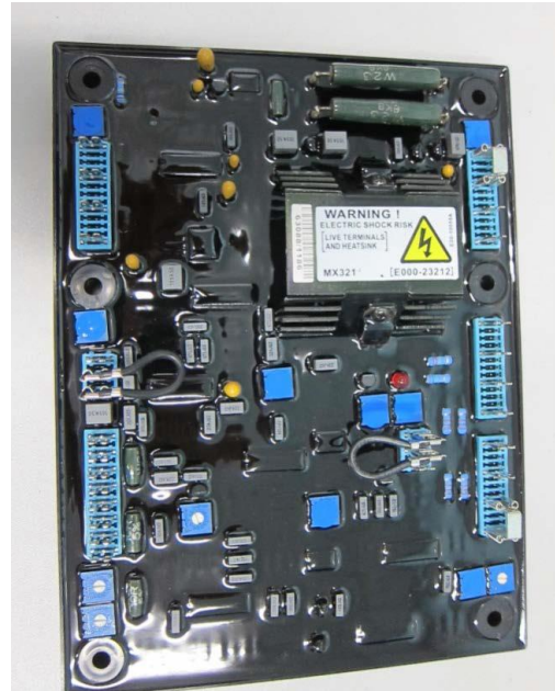
圖 4.12：發電機的自動電壓調節器
