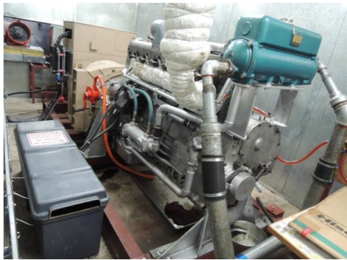
圖 4.3 安裝在測試台之吉拿發動機
