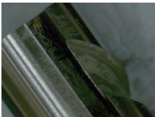
圖 5.8. 燃油泵柱塞的放大圖 (進行高硫柴油測試前)
