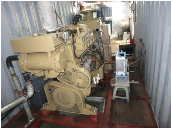
圖 4.7. 安裝在測試台之康明斯發動機
