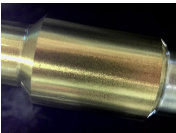
圖 6.8. 燃油泵柱塞的放大圖 (進行高硫柴油測試前)
