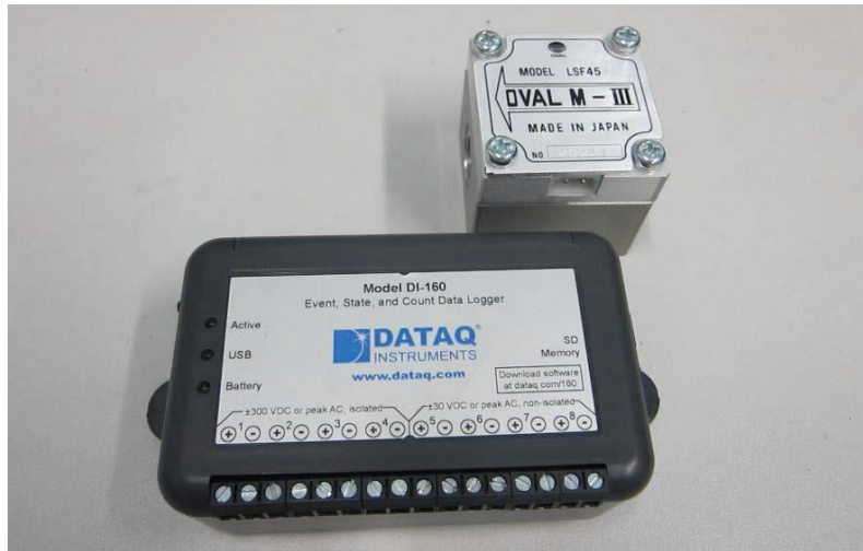
圖 4.13：燃油流動感應器連數據記錄儀
