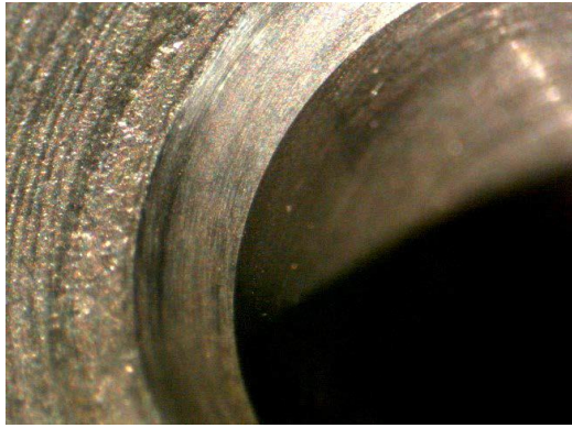
圖 5.10. 燃油泵輸送的放大圖 (進行高硫柴油測試前)
