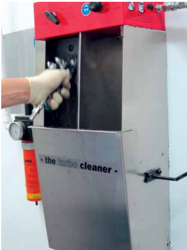
以上噴槍快速清洗機(相片)的左邊是用作清洗用途，而右邊則是用作吹乾噴槍
