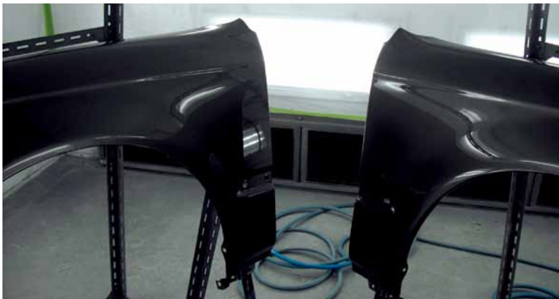
左邊的工作件是用水溶性色漆噴塗，右側的工作件則用了傳統溶劑性色漆噴塗，兩者的色澤並無甚分別
