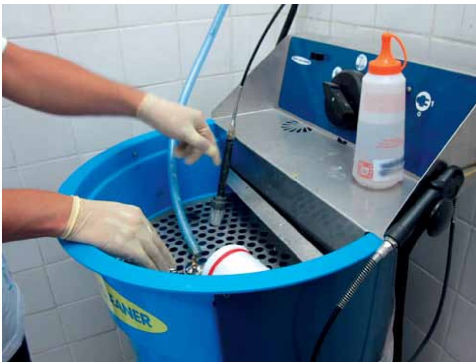
水溶性漆噴槍清洗機的上層部份是用作清洗噴槍
