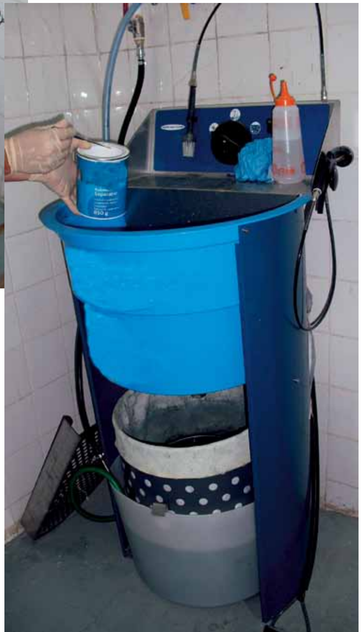
加添少許水溶性漆凝固劑在廢漆水中，以凝結廢水中的污物及雜質，方便處理廢水
