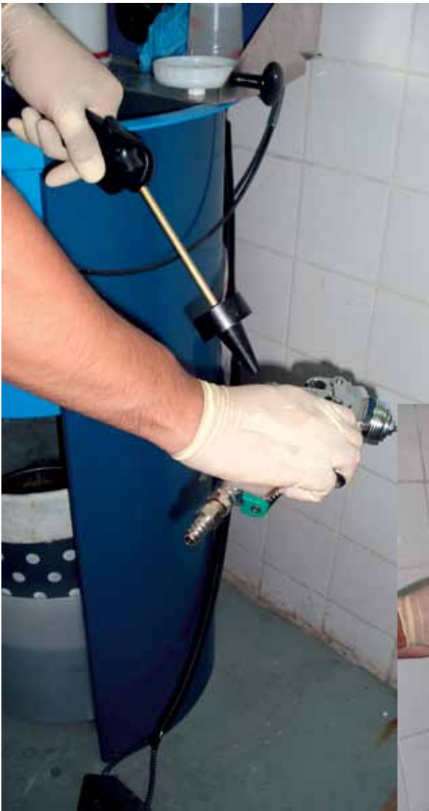
噴槍清洗機附設吹乾系統可將噴槍內殘餘的清潔液清除及吹乾噴槍內的水份
