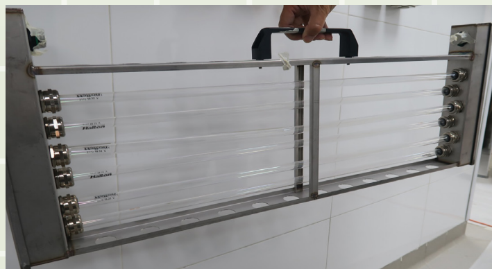
安裝紫外線燈管的燈盤
