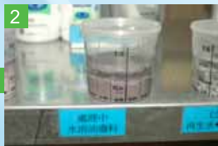
處理中水溶油廢料 (固體廢料慢慢沉澱)
