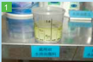
處理前水溶油廢料
