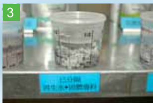
已分隔再生水和固體廢料 (水可循環再用)
