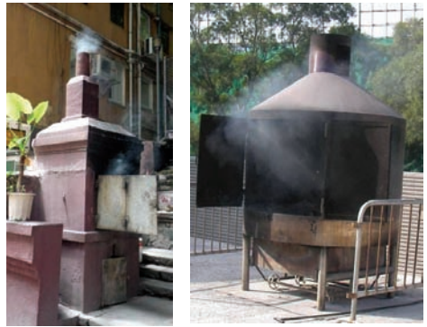
圖2: 用磚塊或金屬製造的紙錢燃燒爐常見例子。
