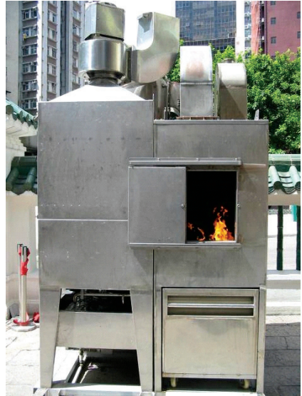
圖3: 採用《最佳可行技術》控制紙錢燃燒爐空氣污染物排放的例子。
