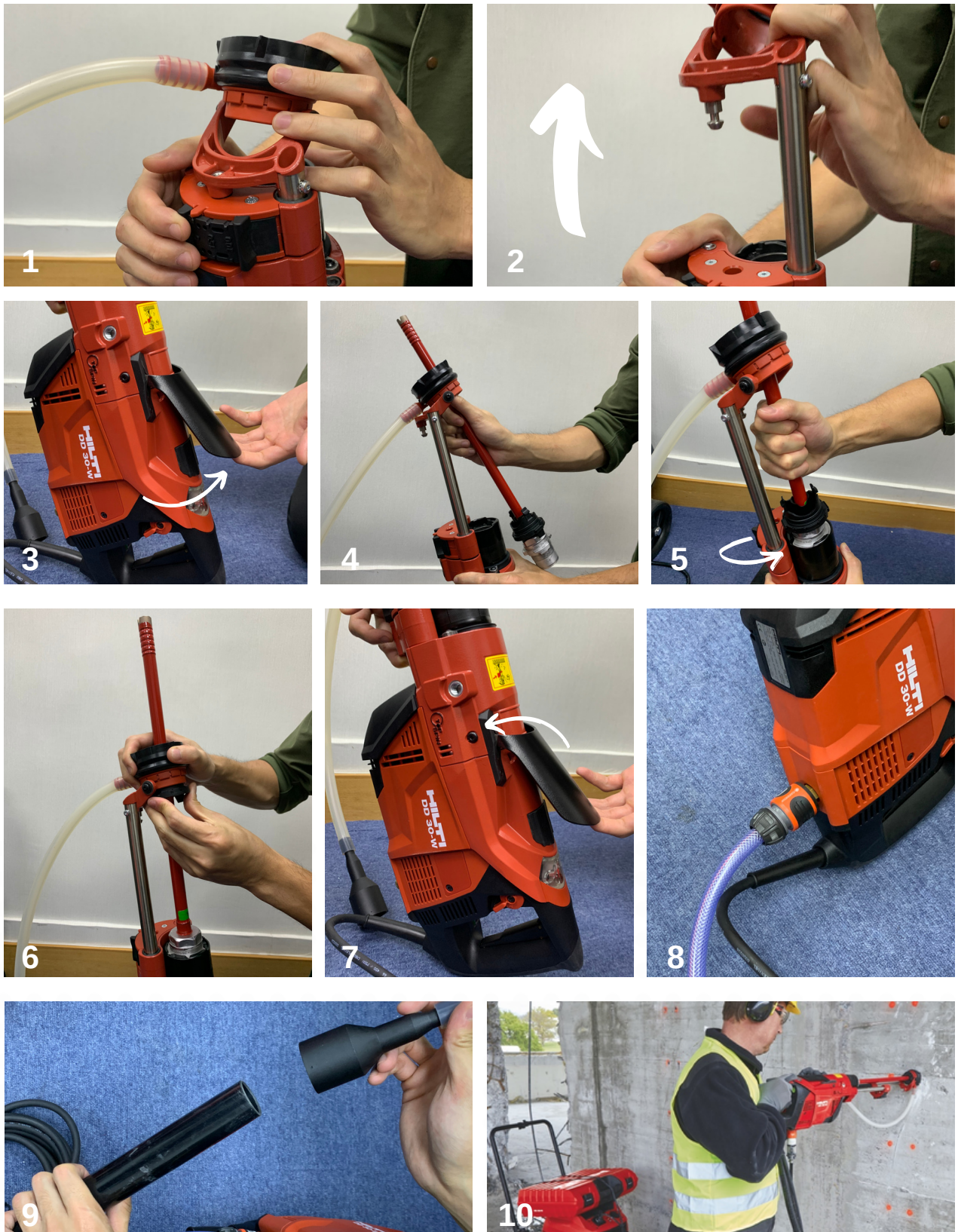
圖2.4 使用鑽孔機進行開孔示意圖 資料來源: 喜利得 4
