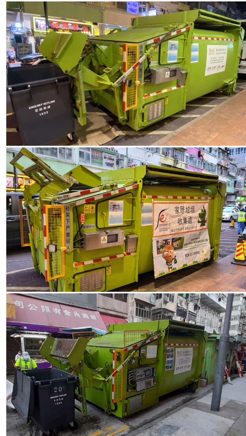
壓縮機收集「三無大廈」居民棄置的廢物
