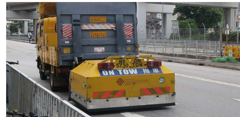
近距離路面噪音測量車在量度路面與輪胎之間產生的噪音
