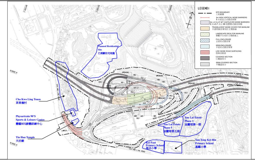
Project Title: Tseung Kwan O – Lam Tin Tunnel and Associated Works 工程項目名稱: 將 軍 澳 – 藍 田 隧 道 及 相 關 工 程 Noise Mitigation Measure at Lam Tin Interchange 藍田交滙處的噪音緩解措施
